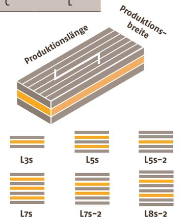
Die Faserrichtung der Decklagen verläuft immer rechtwinklig zu den Produktionslängen.
