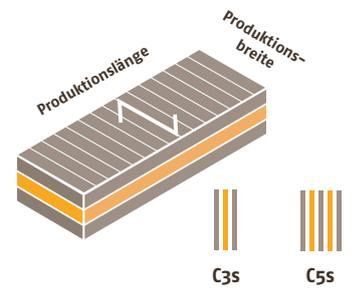
Die Faserrichtung der Decklagen verläuft immer parallel zu den Produktionsbreiten.
